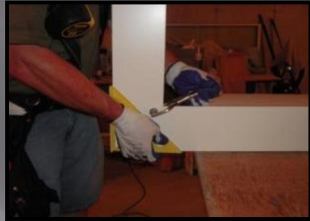
7. DRILL & RIVET ALONG THE SEAM
